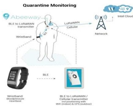
Gambar 1 Blok diagram sistem monitoring pasien menggunakan *wristband vital sign* mendeteksi penyebaran dan monitoring pasien DBD
